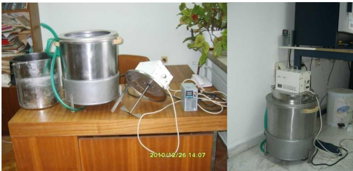
Фиг. 2. Общ вид на опитна уредба за инвертиране на захарен разтвор
